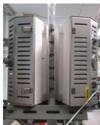
電気炉加熱装置 (反応管: 石英)
